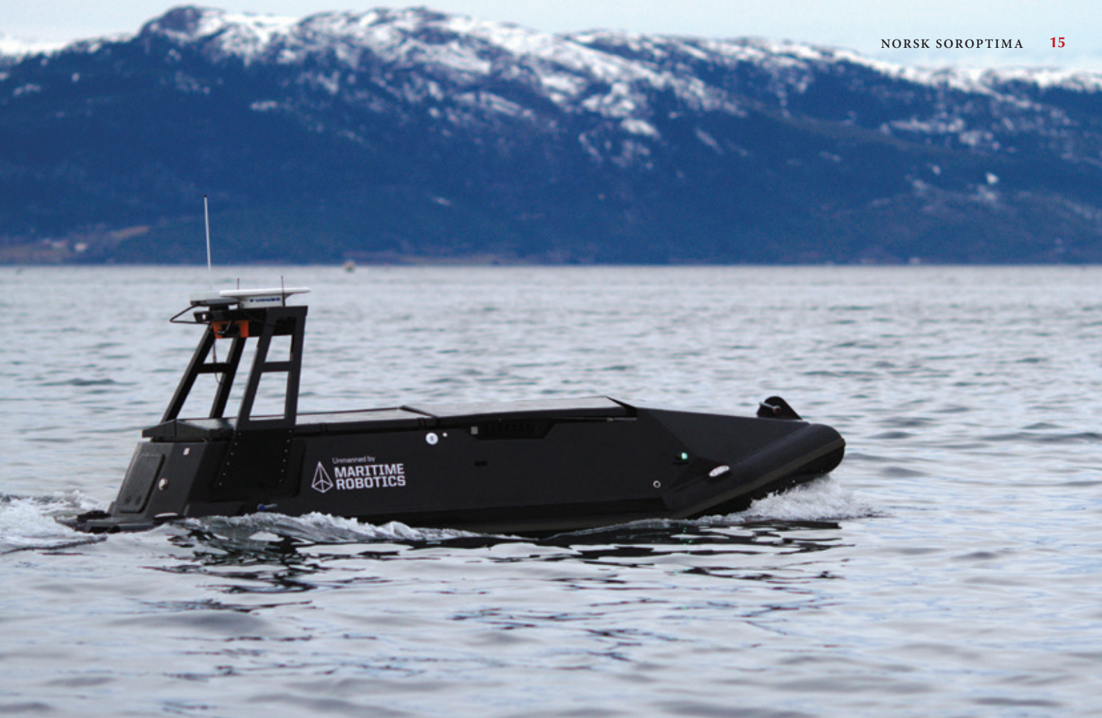
«Mariner» selvgående dieselelektrisk båt. Foto: Maritim Robotics.
